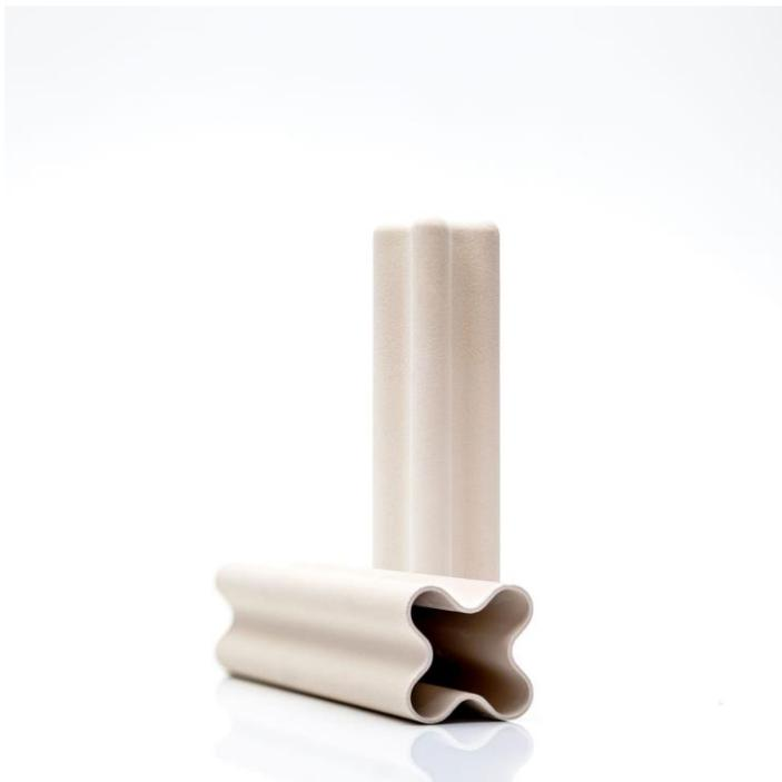
*Schlüsselkomponente für "grünen" NaNiCl-Batteriespeicher: Beta-Aluminiumoxid-Granulat, mit 2000 bar zu Batteriehülsen gepresst*
